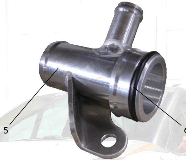
Assembler le tuyau d'entrée de pompe à eau sur la pompe à l'aide de la vis (**rep. 7**) et de la rondelle (**rep. 8**).
